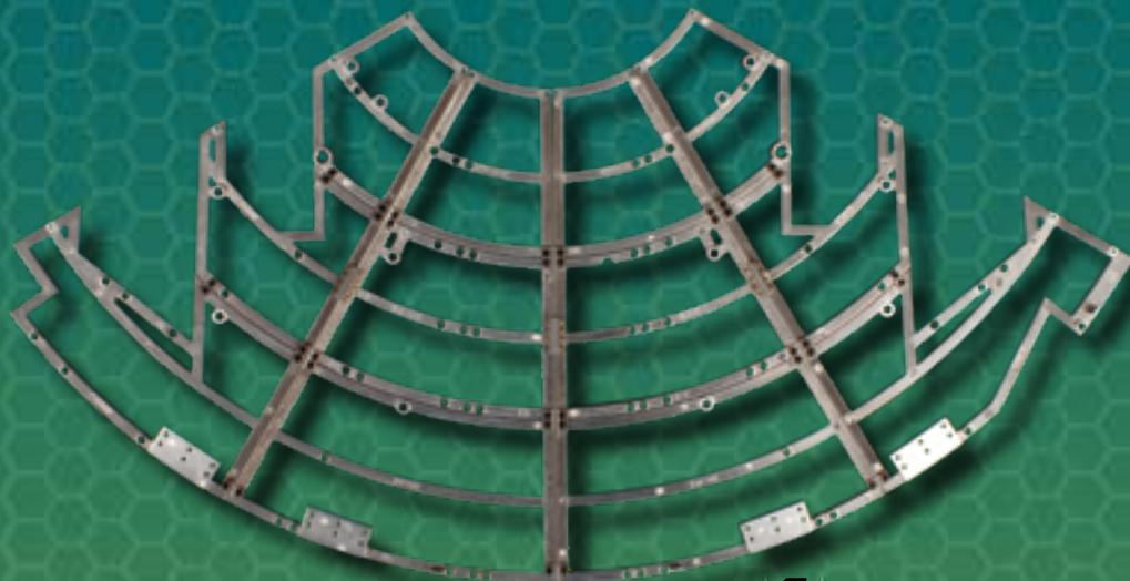
Промежуточный результат сборки. Вы завершили сборку передней 1/3 нижнего каркаса модели. Четыре больших фланца на внешнем крае предназначены для крепления жвал.
